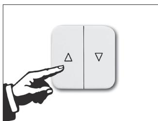
Chiudere completamente la tenda premendo una volta il tasto ▲ (tasto SU).
