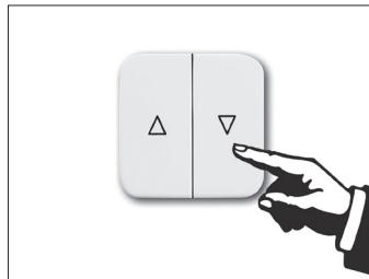
Die Markise mit der ▼ (AB-Taste) vollständig ausfahren.
