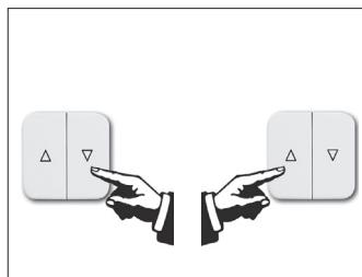
Desenrollar el toldo con ▼ (tecla ABAJO) hasta que sea posible accionar el tope del perfil de caída.
