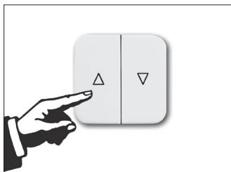
Het zonnescherm met de ▲ (OMHOOG-toets) in het vergrendelings-uitvalprofiel trekken tot de motor automatisch stopt.
