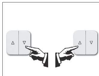
Déployer le store en appuyant sur la touche BAS ▼ jusqu'à ce que l'arrêt de la barre de chute puisse être déverrouillé manuellement.
