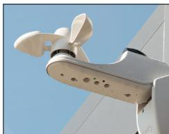
Bei vorhandenem Steuerungssystem sollte der mechanische Windsensor periodisch auf Beschädigungen durch externe Einflüsse bzw. auf seine Funktionstüchtigkeit überprüft werden (Drehverhalten bei Wind beobachten). Sollte sich der Windsensor nicht richtig drehen, muss er von einem STOBAG Fachbetrieb überprüft werden.
