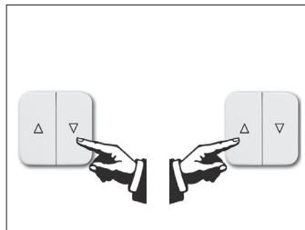
Die Markise mit der ▼ (AB-Taste) ausfahren, bis die Auffallprofil-Arretierung bedient werden kann.
