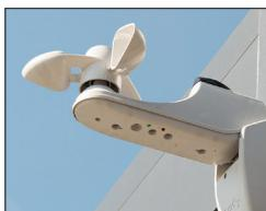
Bij beschikbaar besturingssysteem moet de mechanische windsensor regelmatig worden gecontroleerd of hij beschadigd is door externe invloeden en of hij functioneert (draaigedrach bij wind observeren). Als de windsensor niet juist draait moet hij door een STOBAG specialist worden gecontroleerd.
