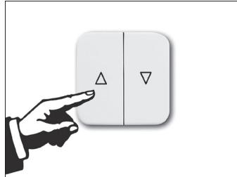
Die Markise mit der ▲ (AUF-Taste) in die Ausfallprofil-Arretierung einfahren,
